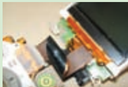
ポリイミドフィルムに銅箔を張り合わせてできたフレキシブル基板
