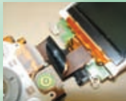
ポリイミドフィルムに銅箔を張り合わせてできたフレキシブル基板
